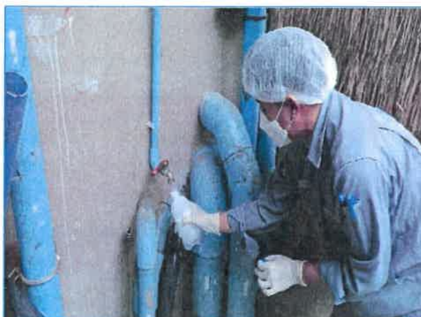
ภาพที่ 3.4.5-1 การตรวจวัดคุณภาพน้ำใช้ บริเวณก๊อกน้ำใช้ที่ผ่านการกรองของโครงการแล้ว ก๊อกน้ำใช้อาคาร G (GSP 47P 417200, 957907)
